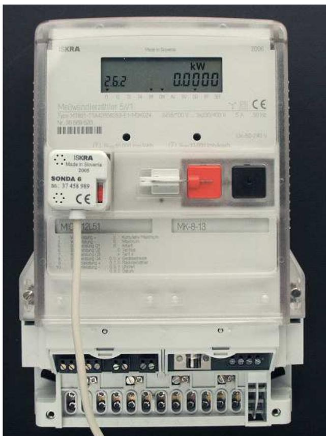
Figure a – Lettura dei dati "senza alimentazione" con SONDA 6 (opzionale, per MT830/MT831)
